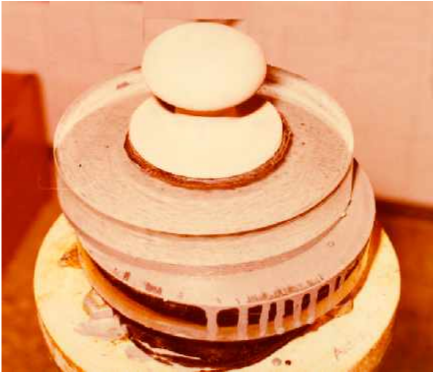
Abbildung 5.6: Spiegel auf der Schleifschale
