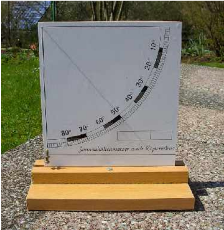
Abbildung 5.5: Der Sonnenshöhenmesser zeigt die Sonnenshöhe für 49,07^\circ N am 17.4.2010 um 14:15 MEZ
