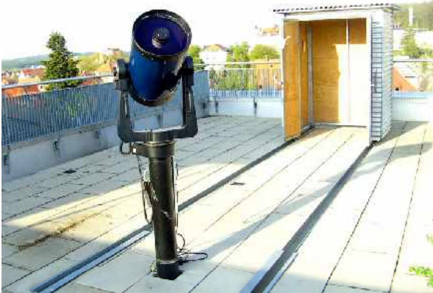
Abbildung 5.2: Das Neue Spiegelteleskop mit abgefahretem Schutzbau
