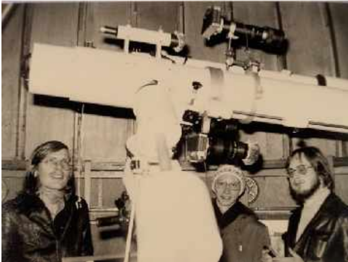
Abbildung 5.4: Saturnbedeckung vom 11.12.1973 um 2:00 Uhr MESZ Die Schüler der Arbeitsgruppe Astrofotografie unter dem mit Fotoapparaten bestückten Coudé-Refraktor
